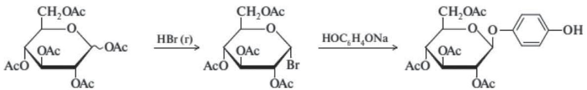
Рис. 2. Схема синтеза гликозида арбутина в виде ацетата
